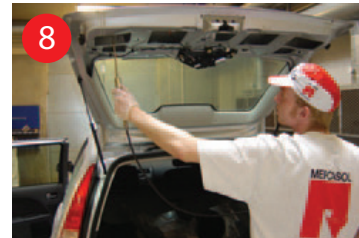
8 Behandling af overvogn i samtlige lukkede hulrum, døre, klapper, stolper m.v. med et tyndt penetrerende produkt.
