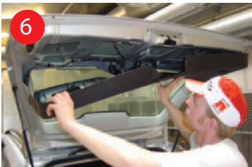
6 Afmontering af overvogn ifølge sprøjtediagram af dørkontakter, plastafdækninger samt fugt-absorberende materialer m.v.
