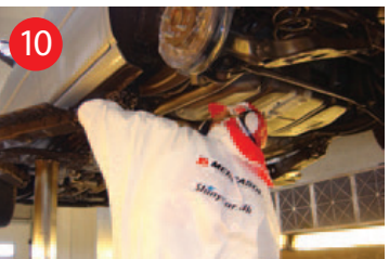
10 Behandling af undervogn i samtlige lukkede hulrum samt hjulkasser og vognbund med et tyndt penetrerende produkt.
